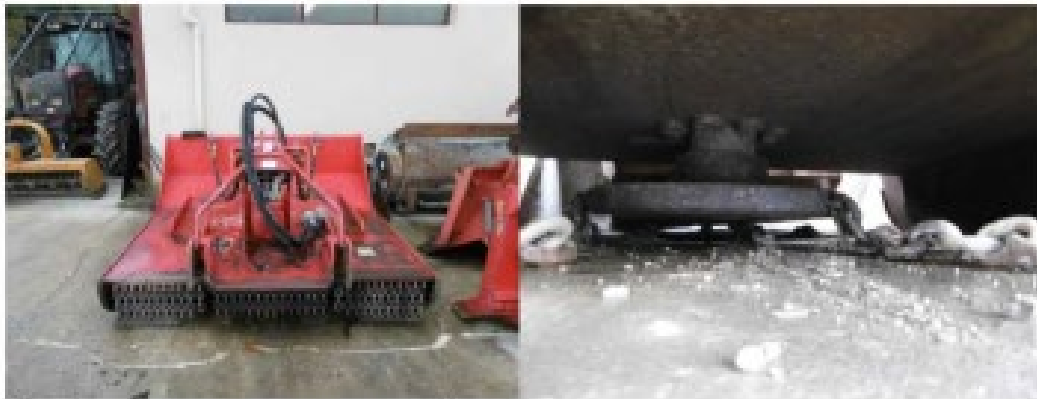
Broyeur Grenier Franco à axe vertical
